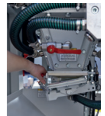
Wartungsklappe am Fülltopf
