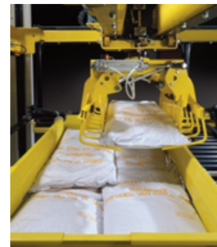
Der Palettierer Serie 4000 wird in der Baustoffindustrie eingesetzt und eignet sich für Leistungen von 2.500 bis 4.000 Säcken/h.
