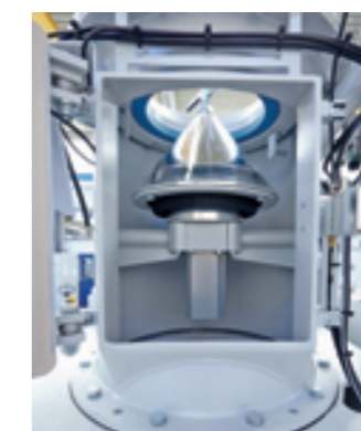
Wartungsklappe an der Druckkammer
