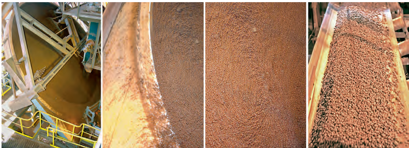
Bild 4: Ausschnitte aus dem Agglomerationsprozess mittels Pelletierteller Fig. 4: Photos of the pelletizing process using pelletizing discs
