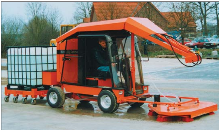
Optimas Hydraulik-Einkehrbesen mit Wasserwagen , Tankinhalt 1.000 Ltr., zum Einschlämmen des Fugenfüllmaterials. Das Wasser wird dorthin geleitet, wo die rotierenden Besen das Sand-Wasser-Gemisch herstellen und in die Fugen einarbeiten.
