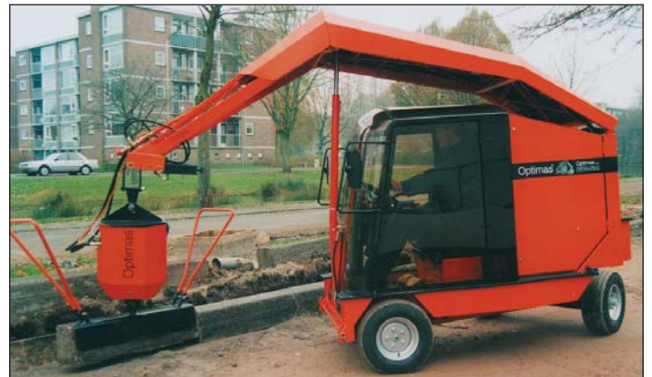
Optimas Vakuumeinheit zum Setzen von Bordsteinen. Hier ist die Saugplatte in angewinkelter Form ausgebildet. Die Saugfläche ist dadurch größer, und das Ansaugen wird erleichtert und ist sicherer.
