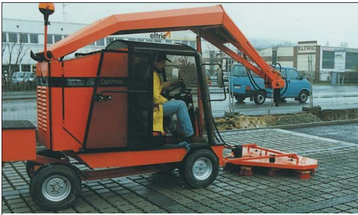
Optimas Hydraulik-Einkehrbesen , zum Füllen der Pflasterfugen, Arbeitsbreite ca. 1,60 m. Durch 24 ineinandergreifend rotierende Besen wird das Füllmaterial in die Fugen eingearbeitet. Auch ideal für Rasengittersteine und „Öko-Pflaster“.
