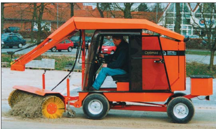
Optimas Hydraulik-Walzbesen zum Kehren (Reinigen) von Baustellen und Hofflächen. Arbeitsbreite ca. 1,60 m. Einstellung der Drehrichtung und Schrägstellung vom Cockpit aus. In Verbindung mit dem Wasserwagen wird intensiv gereinigt und das Aufwirbeln von Staub vermieden.
