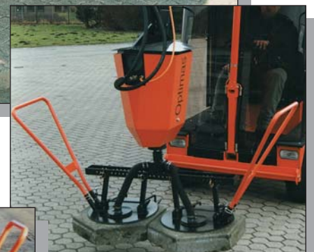
Optimas Vakuum-Einheit für 2 Platten
