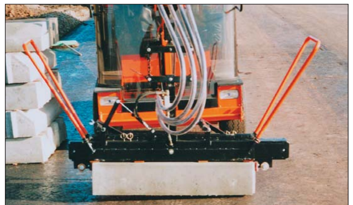
Optimas Hydraulik-Bordsteingreifer zum Setzen von Beton- und Granitbordsteinen von 45 cm bis 1,40 m, greift auch Bordstein-Bögen. Durch das Anbringen von seitlichen Verlängerungen wird die Greifkapazität auf mehr als 2 m erhöht.
