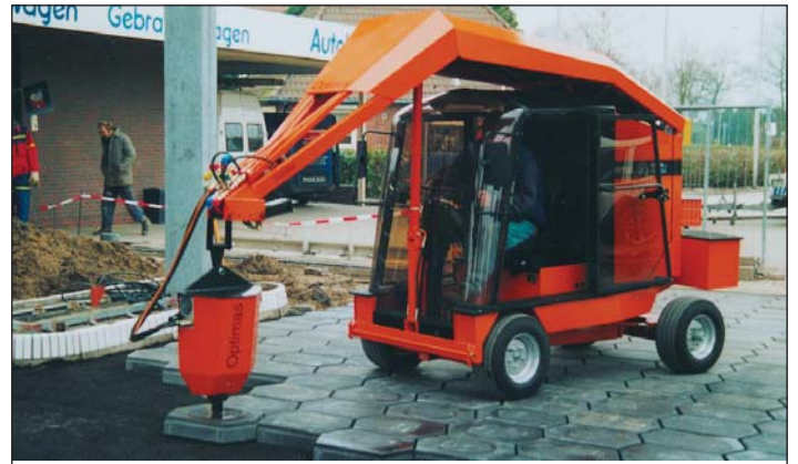
Optimas Vakuumeinheit zum Setzen von Betonteilen. Hier: Verlegung von Tankstellen-Großpflaster. Es können auch 2 Platten gleichzeitig angesaugt werden. Die Ansaugplatten sind in Sekundenschnelle zu wechseln.
