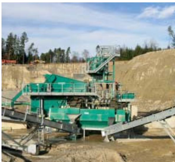
Wasch- und Klassieranlage für stark verunreinigten Moränekies
