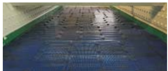
Kunststoffstecksiebböden (Maschenform: Harfe) für verstopfungsfreies Sieben
