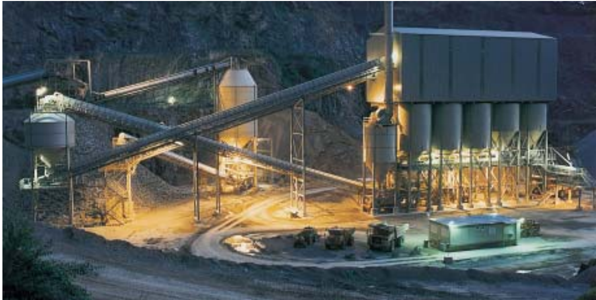
Silo- und Klassieranlage mit NIAGARA-Vorabscheider und fünf NIAGARA-Schwingsieben
