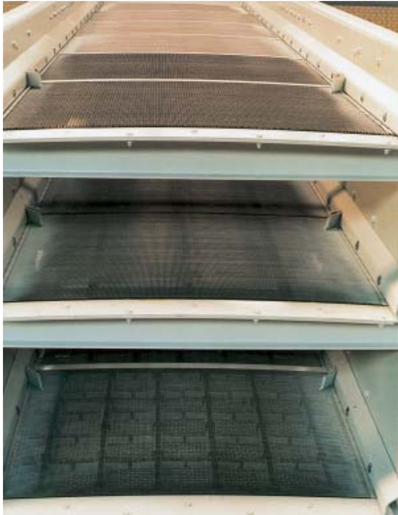
Flachsieb mit Kugelklopfvorrichtung und Seitenabdichtung
