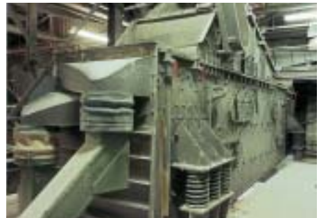
Bild oben: HAYER-Fine-Line mit geöffneten Kontroll- und Wartungsklappen
