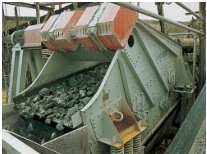
Bild unten rechts: HAYER-Flachsieb mit Richterregger
