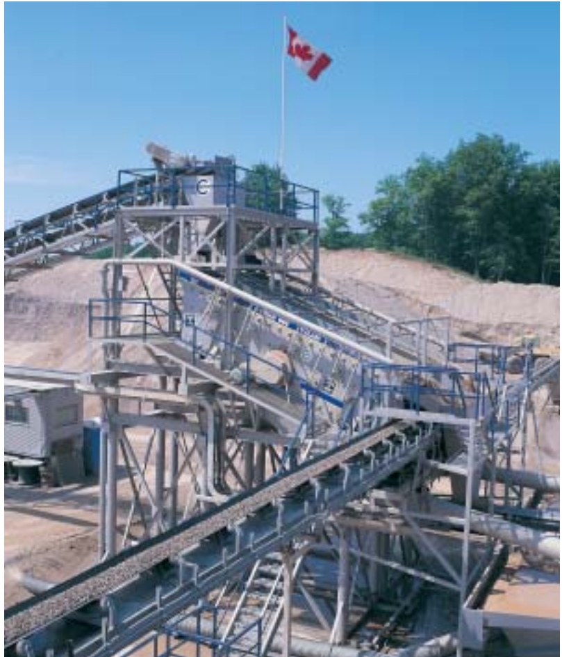
T-CLASS Siebmaschine von W.S. Tyler Canada
