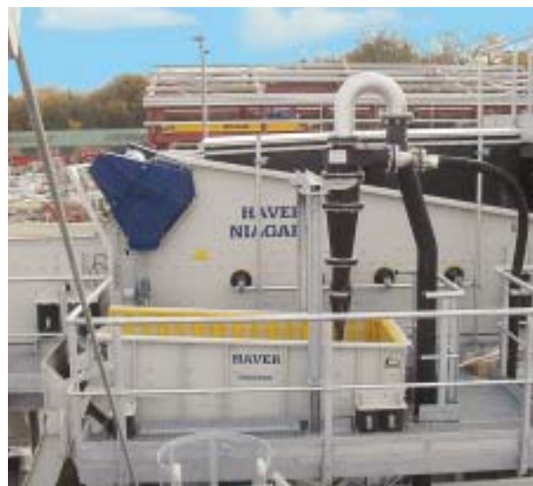
Wasch- und Klassieranlage für Bauschutt
