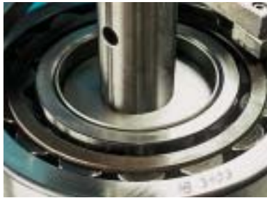
Einpressen einer teflonbeschichteten Buchse
