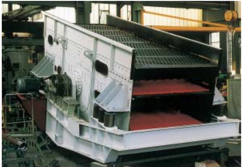
3-Deck-Exzentersiebmaschine belegt mit Lochblechen bzw. Kunststoffstecksiebböden
